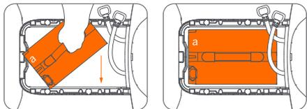
2. Empuje la batería (a) hacia el extremo interior.
