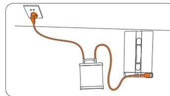
\* El indicador del cargador de la batería muestra un color rojo fijo cuando se carga y se vuelve verde cuando termina.
