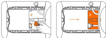
4. Coloque la batería (b) en el compartimento.
