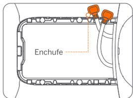
**NOTA:** Antes de la instalación, asegúrese de que no haya ningún objeto extraño en el compartimiento de la batería con dos enchufes en el interior.
