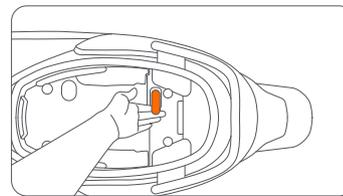
2. Abra el reposapiés del conductor, que es también la tapa del compartimento de la batería, y saque la batería.
