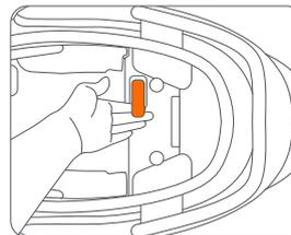
a. Abra el compartimento del asiento con su llave y tire del interruptor del panel del pie para desbloquearlo.
